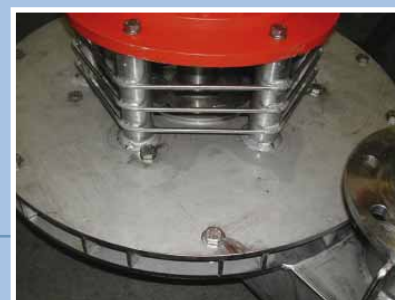
Speciale griglia di protezione per aeratore sommerso tipo SC. Special protection grid for submersible aerator type SC.
